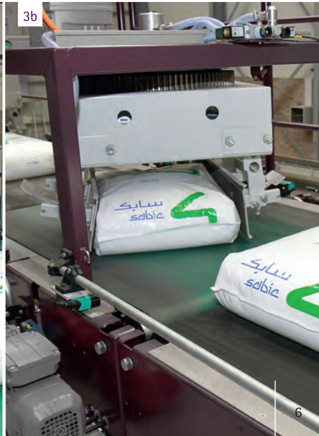
3. Sackausrichtung durch a) Wendeband oder b) Wendeklappen Sackausrichtung durch a) Wendeband oder b) Wendeklappen Bag alignment by a) rotating belt or b) turning flap
