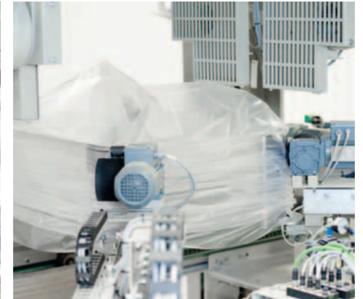
09. Haubenbildung | Aufreffen der auf Länge geschweißten Haube.
