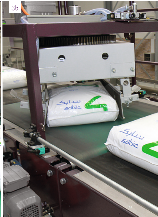
3. Направление мешка при помощи а) поворотного транспортера или б) поворотного клапана Bag alignment by a) rotating belt or b) turning flap
