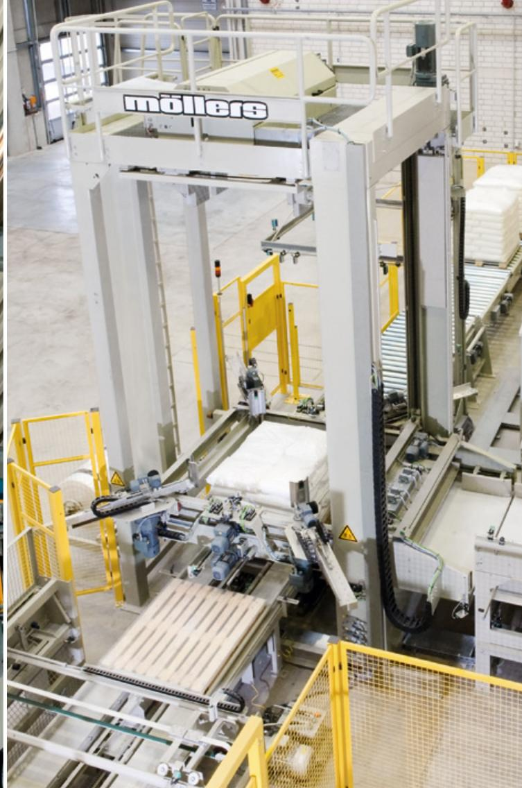
► При ограниченном пространстве рекомендуется машина серии 2 в 1. Она скомпонована из штабелёра с низкой подачей и автомата упаковки в стретч-чехол. За таким сочетание двух основных технологий в одной машине без дополнительной техники транспортировки будущее.
