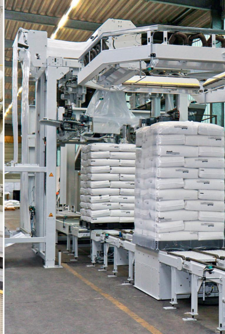
► Комби-установка упаковки в стретч-или термоусадочную пленку: Такое комбинирование объединяет преимущества обеих технологий в одной универсальной машине. Применение: одна обычная термоусадочная установка дополняется DUO HSA, и обе пленки могут использоваться в зависимости от потребностей.
