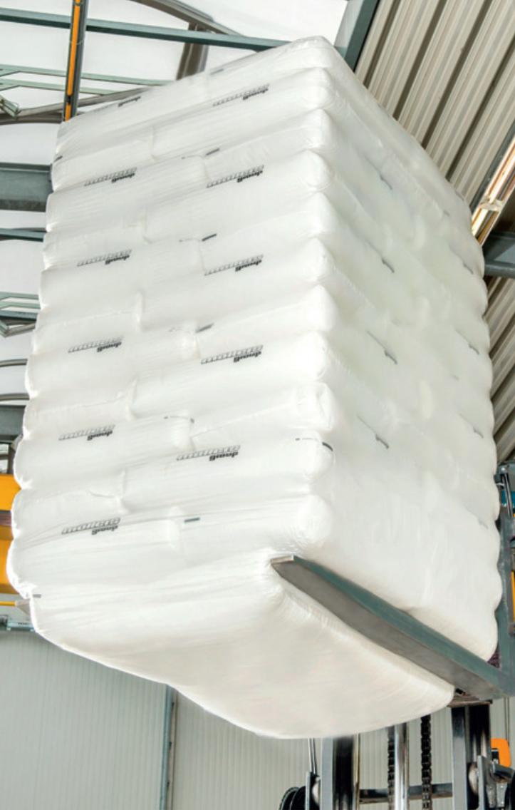
► При бесподдонной технологии пакетирования сама пленка становится поддоном. 2-х или 4-х ходовая бесподдонная грузовая единица оптимизирует таким образом комбинированные грузоперевозки по всему миру. Расходов на поддоны нет, упаковочная пленка полностью перерабатывается и благодаря снижению выброса CO2 положительно влияет на экологический баланс.
