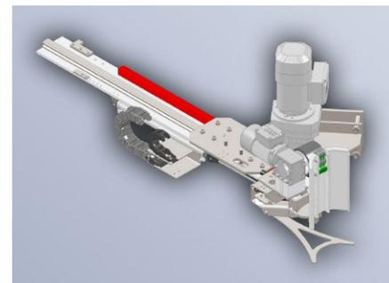
» Stretcharm mit Zahnstangenantrieb
