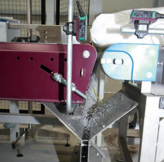
► Links – Kontrolle: Eine oder mehrere Sackbruchkontrollen erhöhen die Sicherheit und Qualität der Verpackungslinie.
