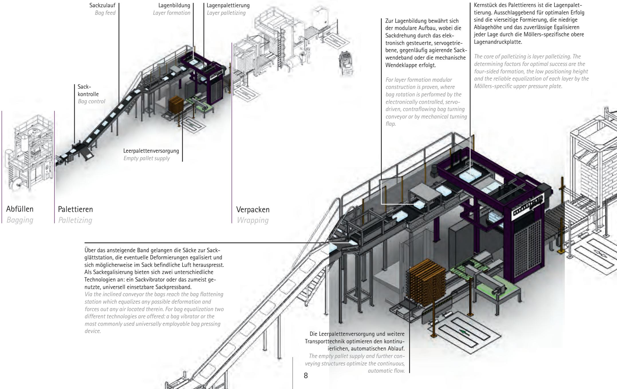
Zur Lagenbildung bewährt sich der modulare Aufbau, wobei die Sackdrehung durch das elektronisch gesteuerte, servogetriebene, gegenläufig agierende Sackwendeband oder die mechanische Wendeklappen erfolgt.
