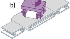
3. Sackausrichtung durch a) Wendeband oder b) Wendeklappen
