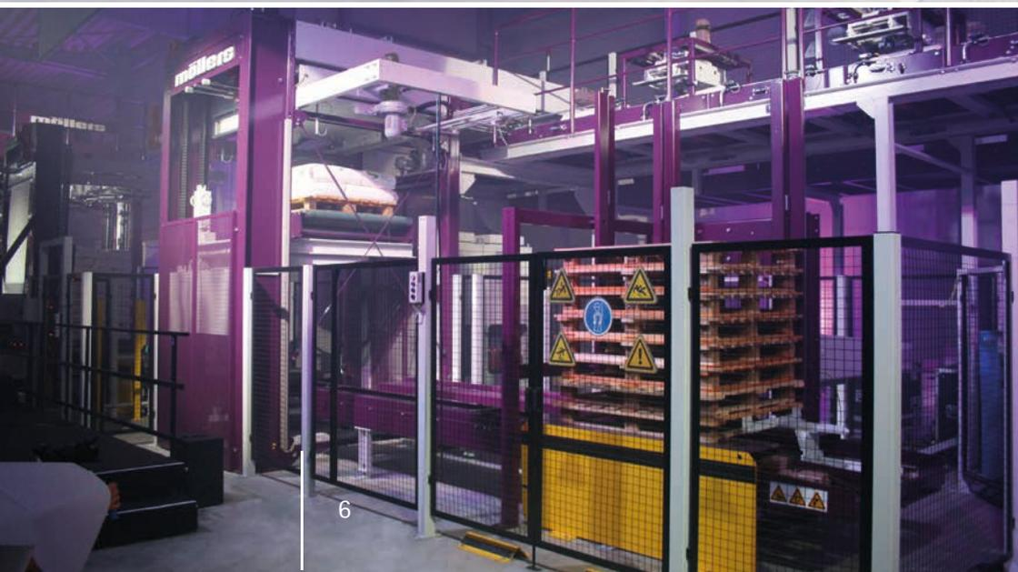
► Die palettenlose Linie PSH-Vario: Dank Paketwendevorrichtung wird die palettenlose Versandeinheit doppelt gestreckt – Kosten für das aufwendige Palettenmanagement entfallen.
