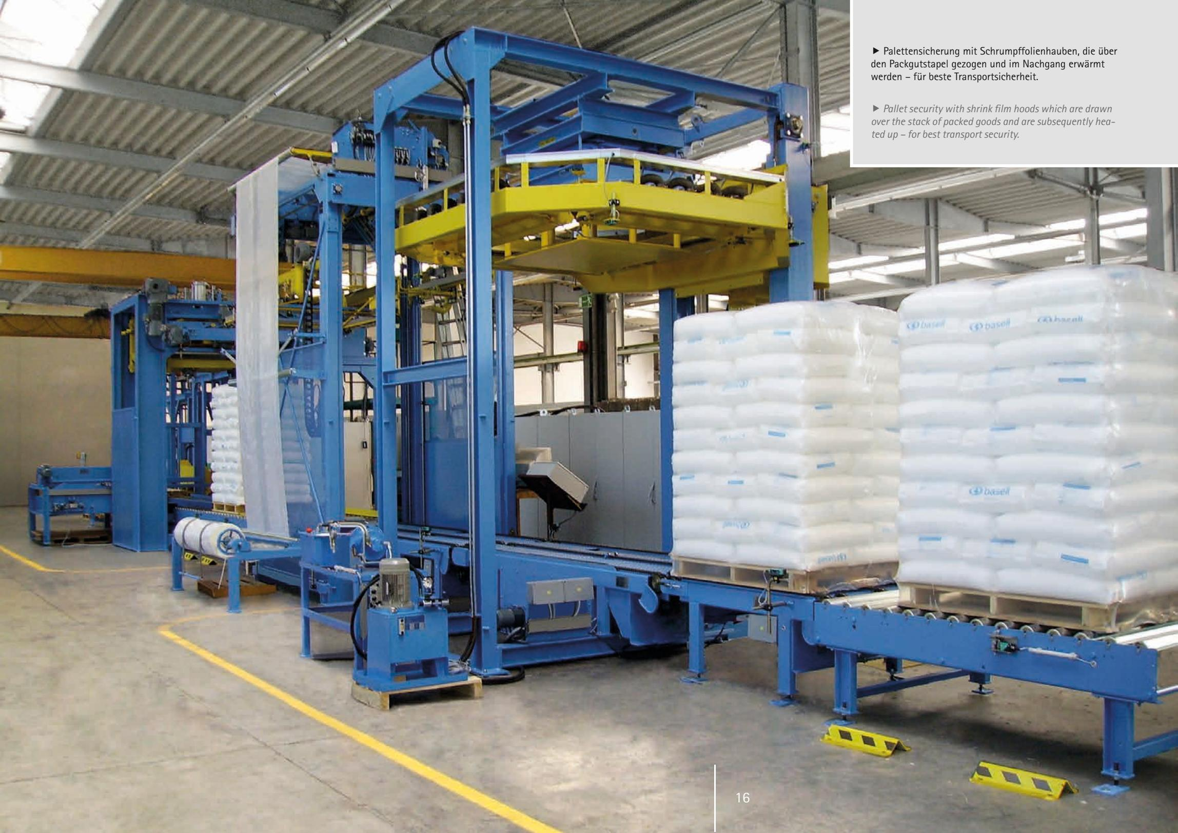
► Palettensicherung mit Schrumpffolienhauben, die über den Packgutstapel gezogen und im Nachgang erwärmt werden – für beste Transportsicherheit.
