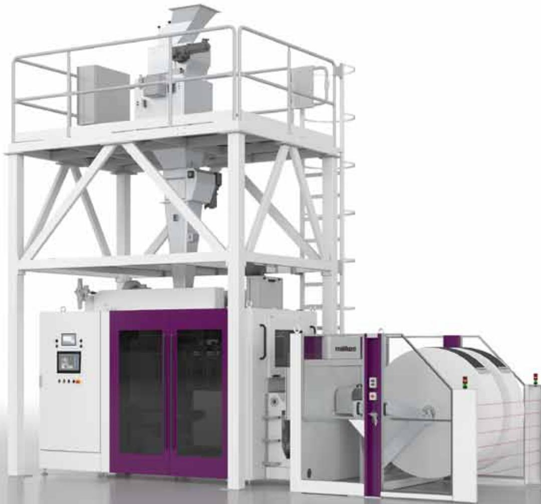
Möllers Packaging Technology GmbH (MPT) präsentiert die neue Highspeed Form-Fill-Seal-Anlage (**HSB-2600**) für Kunststoffgranulate mit einem Abfüllgewicht von 5 bis 50 kg. Sie bietet ein einzigartiges Anlagenkonzept für maximale Ressourceneffizienz bei höchster Produktionsqualität von bis zu 2.600 Säcken pro Stunde. Die **HSB-2600** produziert platz- und material-sparende Säcke. Dank der Eckenschweißung für einen vierkantigen Sackboden lassen sie sich perfekt auf Paletten stapeln.
