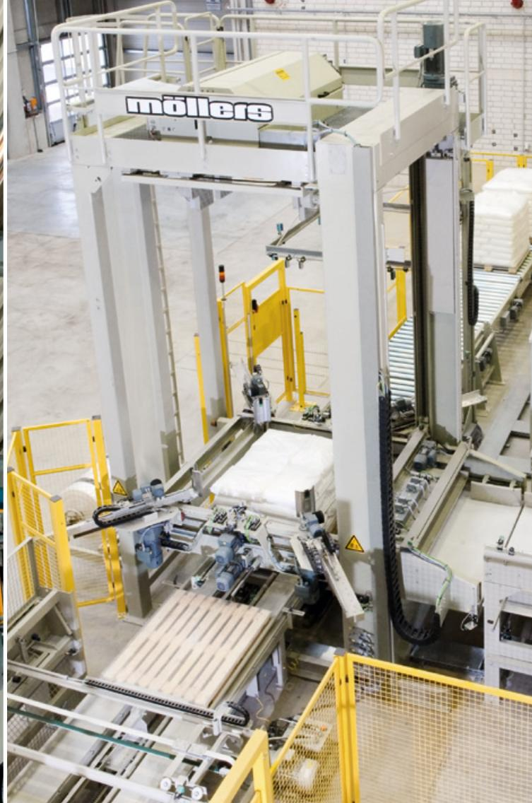
► Bei begrenztem Platz empfiehlt sich die 2in1 Serie. Diese kombiniert den Flurmodulpallettierer mit einem Haubenstretchautomaten. Die Kombination von zwei Kerntechnologien in einer Maschine ohne zusätzliche Fördertechnik ist zukunftsweisend.
