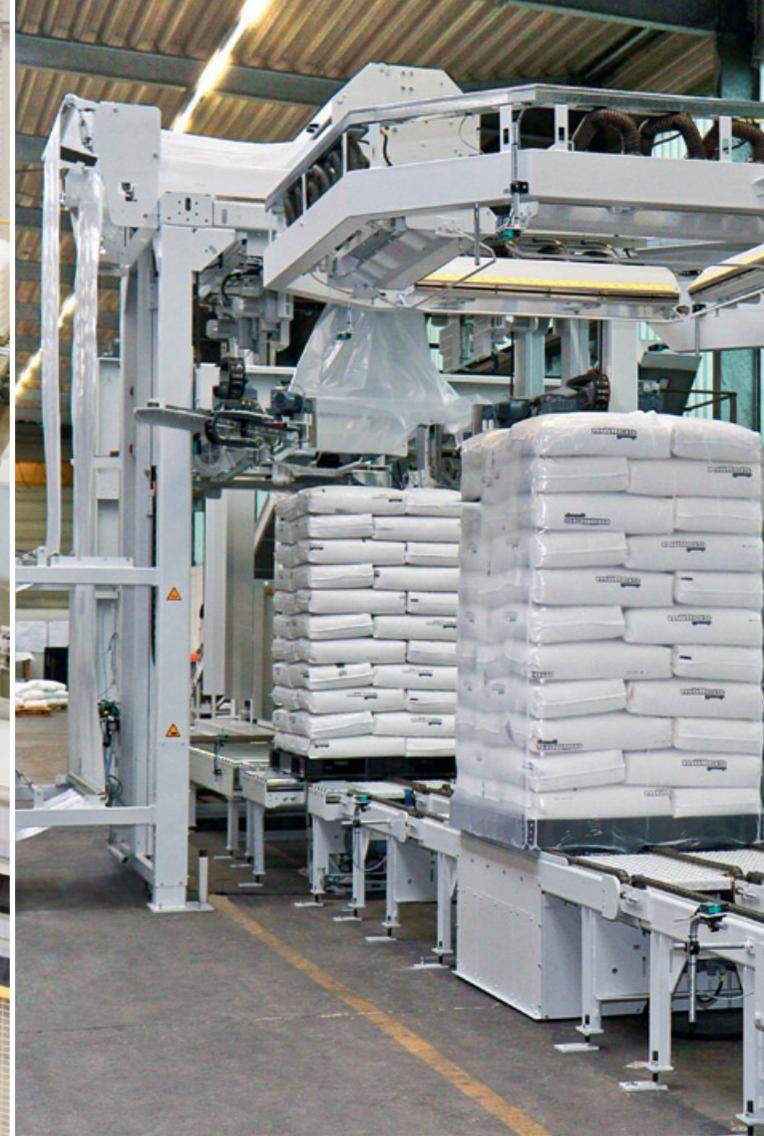
► Kombi-Stretch-Schrumpfanlage: Diese Kombination vereint die Vorteile beider Techniken in einer Universalmaschine. Im Einsatz: eine herkömmliche Schrumpfanlage, ergänzt um den DUO HSA – beide Folien können bedarfsorientiert verarbeitet werden.
