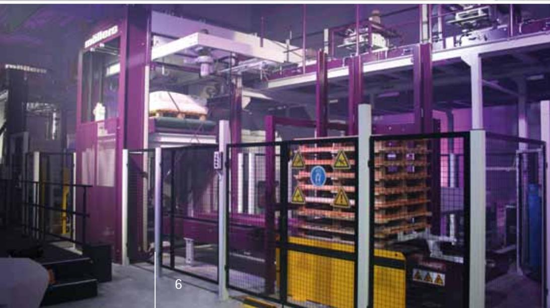
► Weltweit einmalig: das Lernen an der weltweit einzigen palettenlosen Linie PSH-Vario im Produktionsmaßstab. Dank Paketwendevorrichtung wird die palettenlose Versandeinheit doppelt gestreckt – Kosten für das aufwendige Palettenmanagement entfallen.
