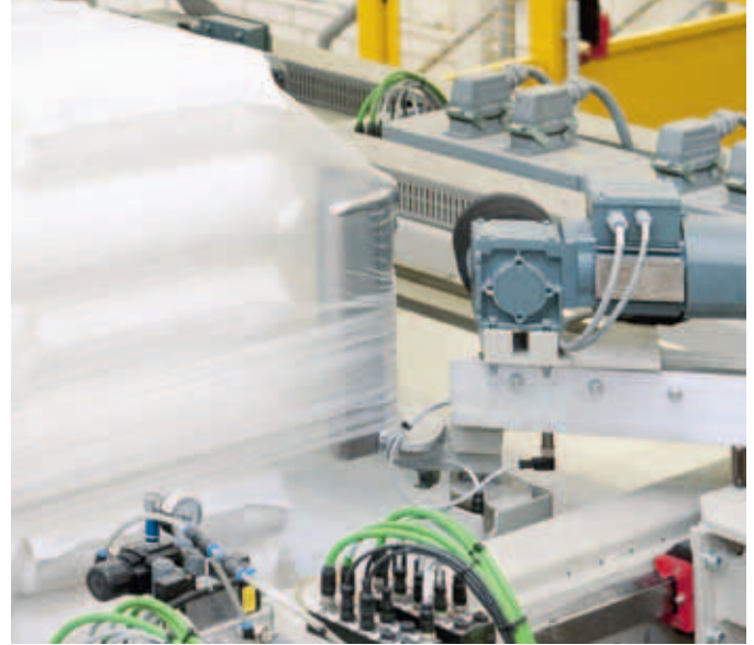
11. Folienüberzug | Hohe Rückstellkräfte für sicheren Halt der Ladung auf der Palette.
