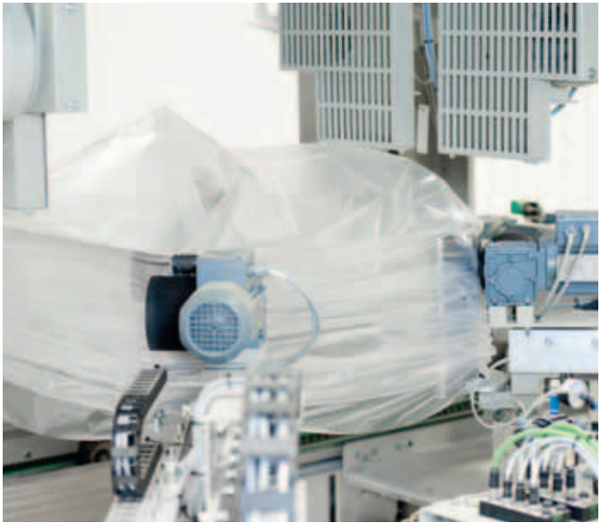
09. Haubenbildung | Aufreffen der auf Länge geschweißten Haube.
