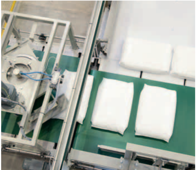
02. Sanfte Sackformierung | Packgutlagen werden nach individuellen Vorgaben gebildet.
