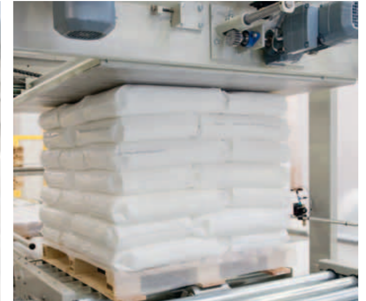
06. Lagenpressen | Die Lage wird durch Anpressdruck egalisiert.
