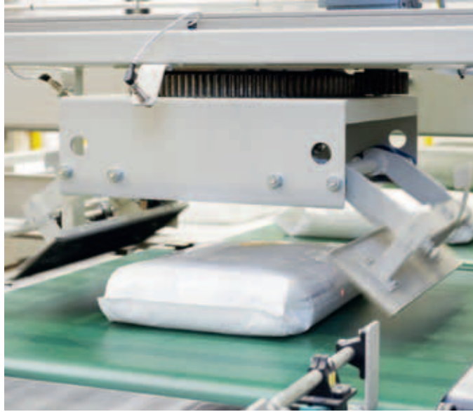
01. Niedriger Sackeinlauf | Der niedrige Zulauf gibt Überblick über den Arbeitsprozess.
