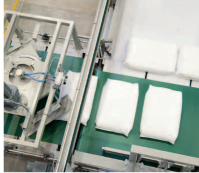
02. Sanfte Sackformung | Packgutlagen werden nach individuellen Vorgaben gebildet.
