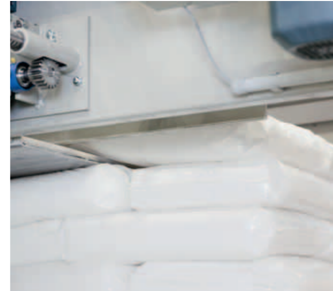
05. Minimale Ablagehöhe | Aus geringer Höhe wird das Packgut abgelegt.
