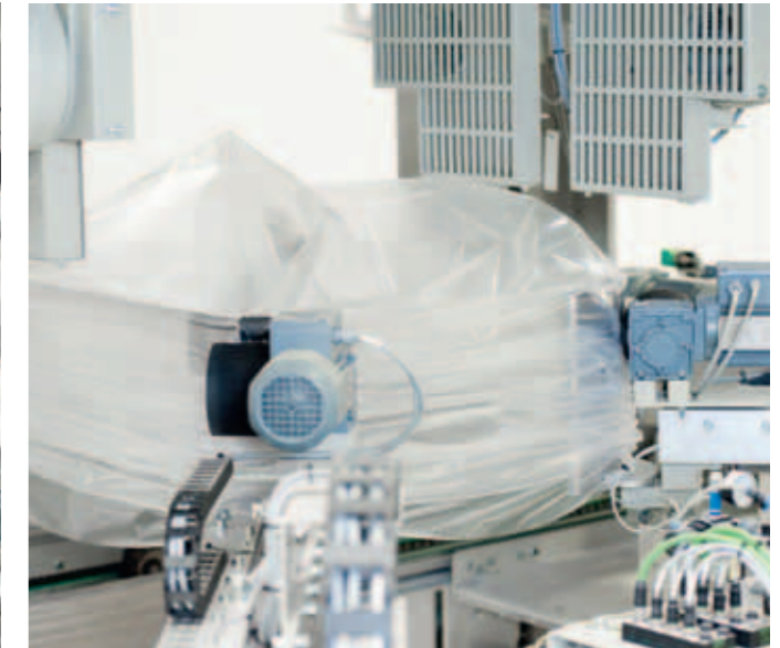
09. Haubenbildung | Aufreffen der auf Länge geschweißten Haube.
