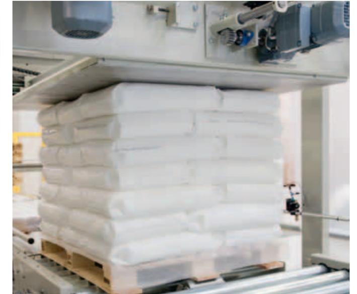
06. Lagenpressen | Die Lage wird durch Anpressdruck egalisiert.
