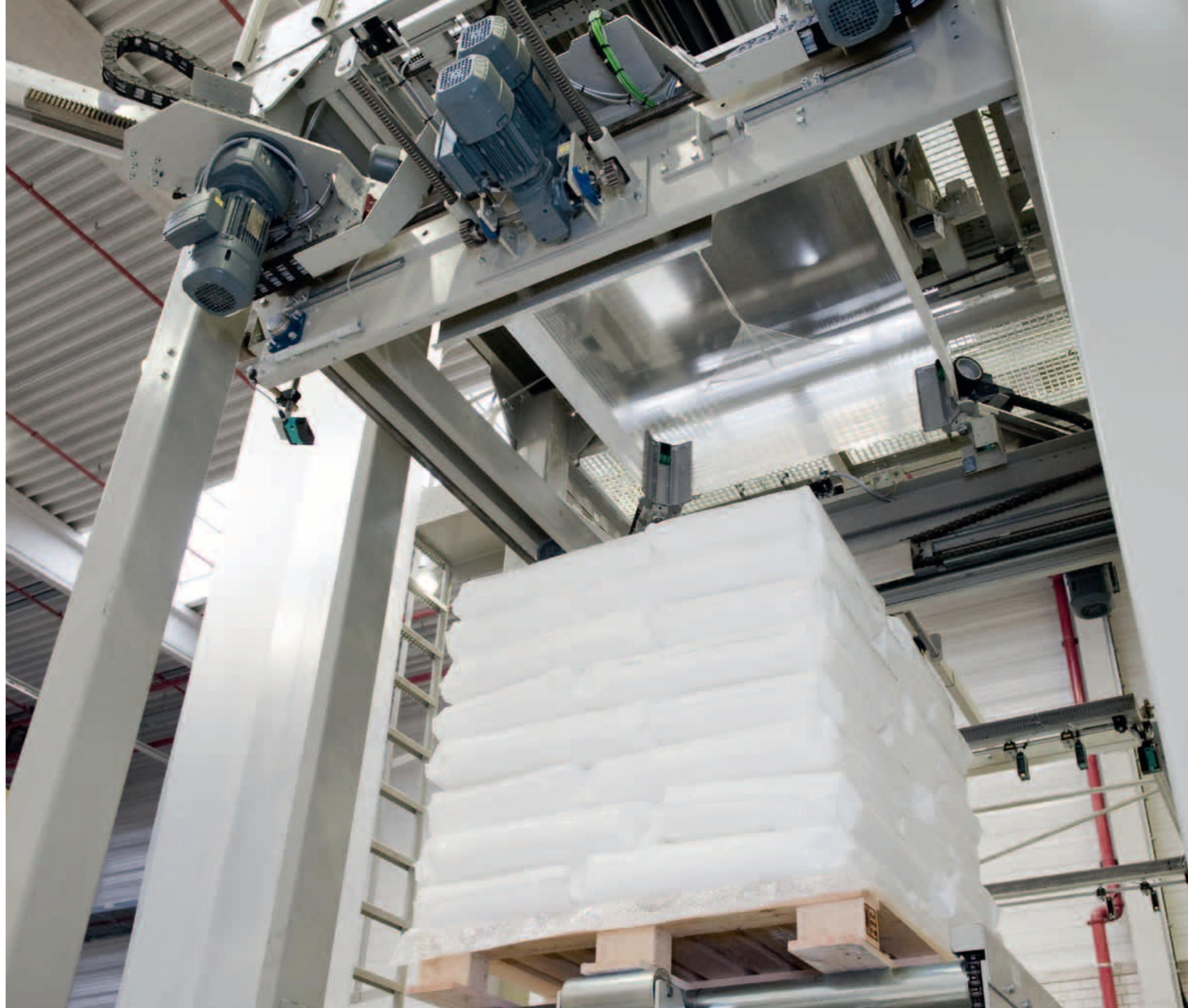
03. Lagenpalettierung | Die Lage wird zur Palette gebracht und darauf positioniert.
