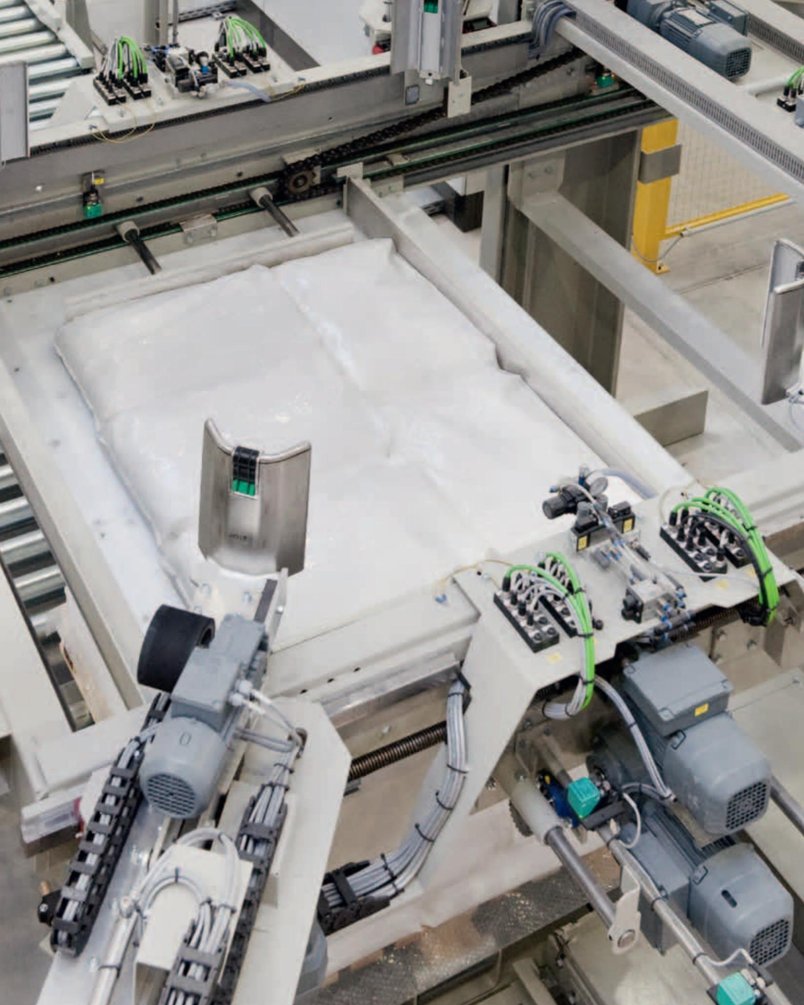
04. Lagenformierung | Auf Längs- & Querseite wird das Packgut formiert und positioniert.
